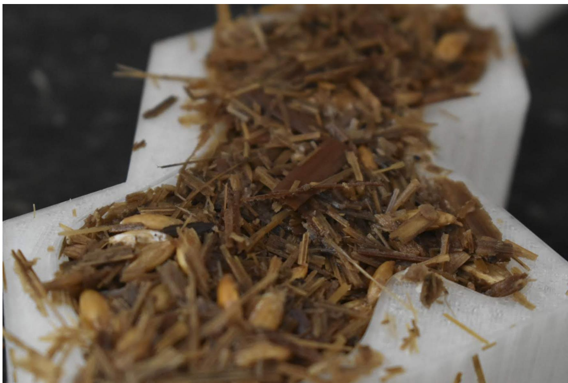
Figura 4: Colocación del sustrato colonizado en el molde de impresión
