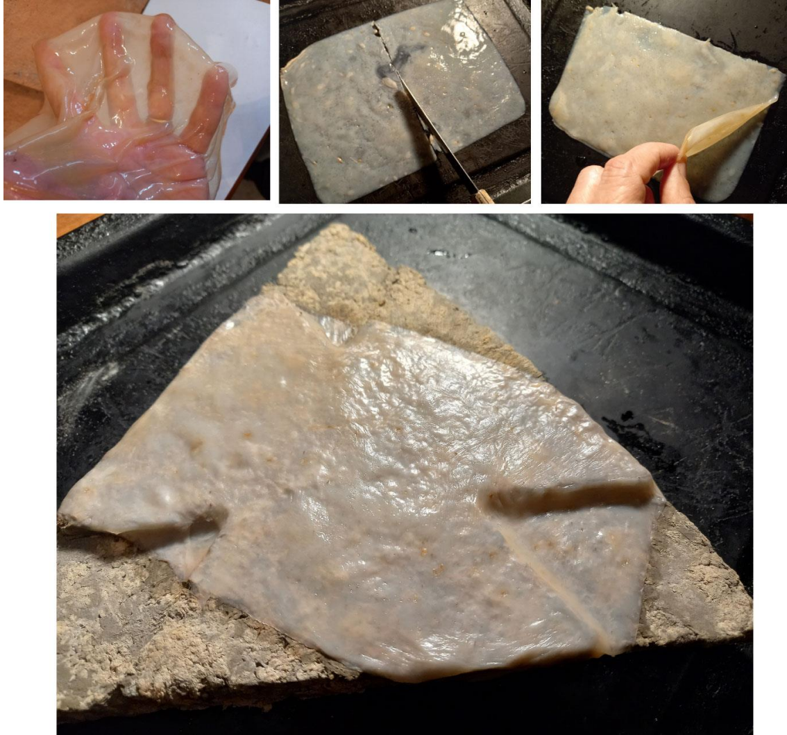
Figura 3: Aplicación de membrana de Celulosa Bacteriana a pieza de papel cemento
