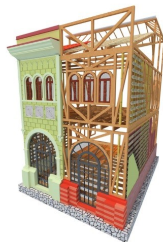
Figura 10: Bahareque de Tierra encementado.
