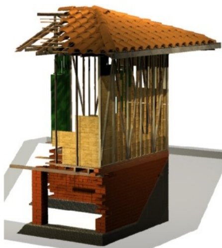
Figura 11: Bahareque de transición. Barrio Chipre Viejo, Manizales. PCC
