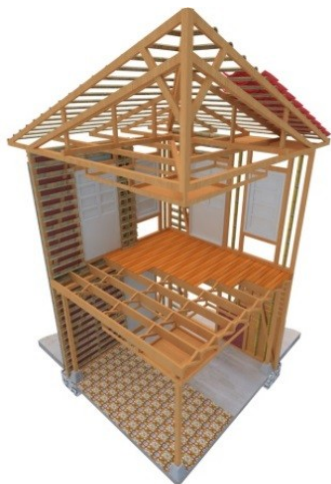
Figura 9: Bahareque de Tierra sobre columnas de madera.
