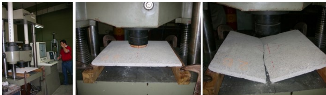
Figura 7. Pruebas llevadas a cabo en el INPRES. Vistas del Ensayo de la loseta 2B. (Blasco Lucas, 2009b; Blasco Lucas y Carestia, 2011a; Blasco Lucas, 2013)
